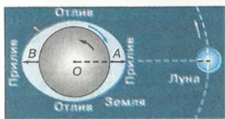
Рис. 3.13. Схема лунных приливов
